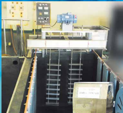
全自動表面処理装置に設置された振動攪拌機
